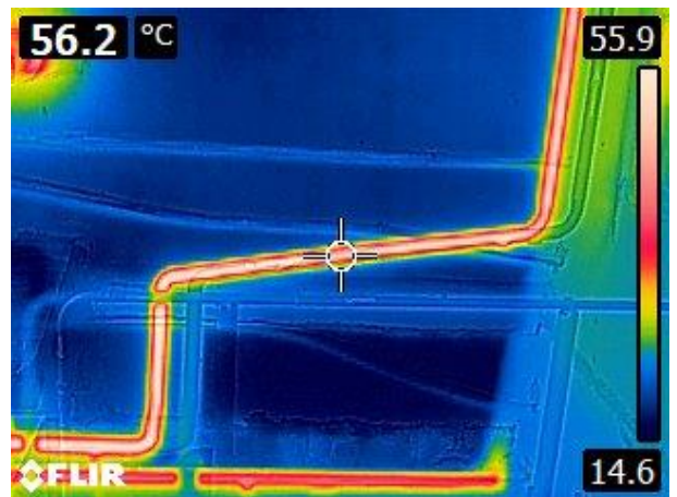
Тепловтрата через неізольовані ділянки трубопроводів в котельні
